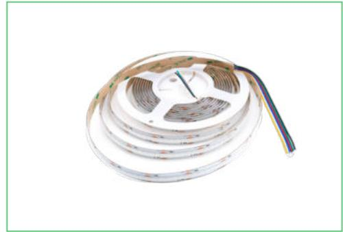
COB RGB CCT LED-Streifen 12 mm mit 840 LEDs/m, 24 V, 21 W/m – RGB + CCT (3000–6000 K), IP33 & IP65, teilbar alle 35,71 mm, Montage im Aluprofil empfohlen.
